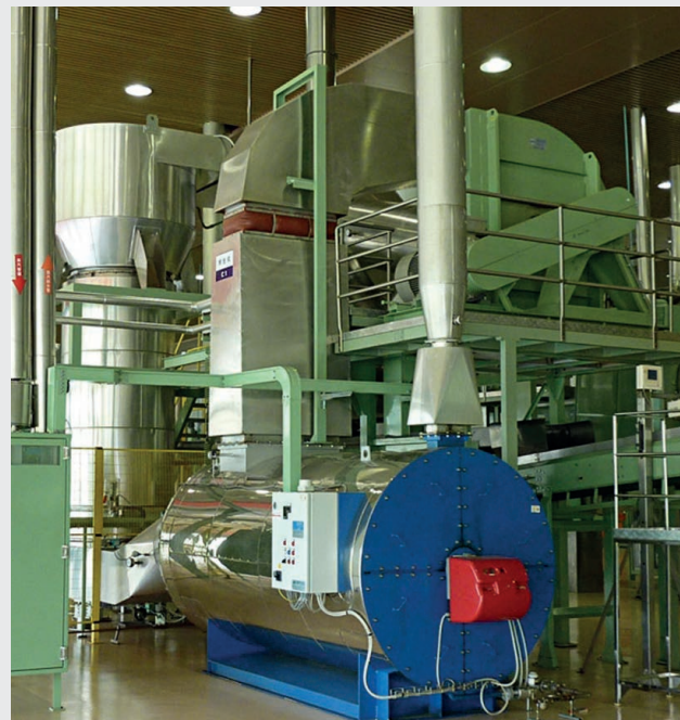
Нагрівання технологічного повітря з високою вологістю за допомогою HTV-N
